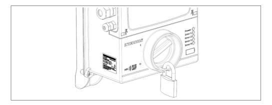
Come elemento di comando viene utilizzato un elemento di commutazione senza contatto. Il sezionatore è chiudibile in posizione "Off", per evitare reinserimenti accidentali dell'alimentatore.
